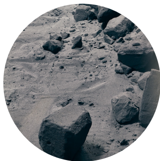
2. Adro (Brescia), Fonderia Ariotti, S.p.A - Sabbie di risulta, utilizzate nel processo di fonderia e successivamente recuperate e riutilizzate nel ciclo.
