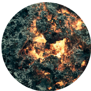
1. Adro (Brescia), Fonderia Ariotti, S.p.A - Le scorie (slag), ovvero il materiale inerte che si separa dal metallo.
